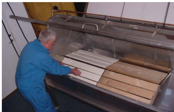
Laboratorieprovning av väderbeständighet (enligt NT Fire 053) hos brandskyddat trä för bruksklass EXT.
