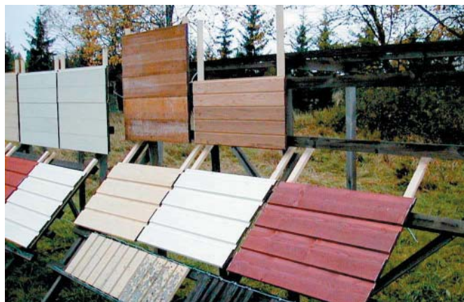
Fältförsök med brandskyddad träpanel för bruksklass EXT.
